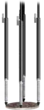
Dickenmessung einer Münze mit 6 mm Tastern
